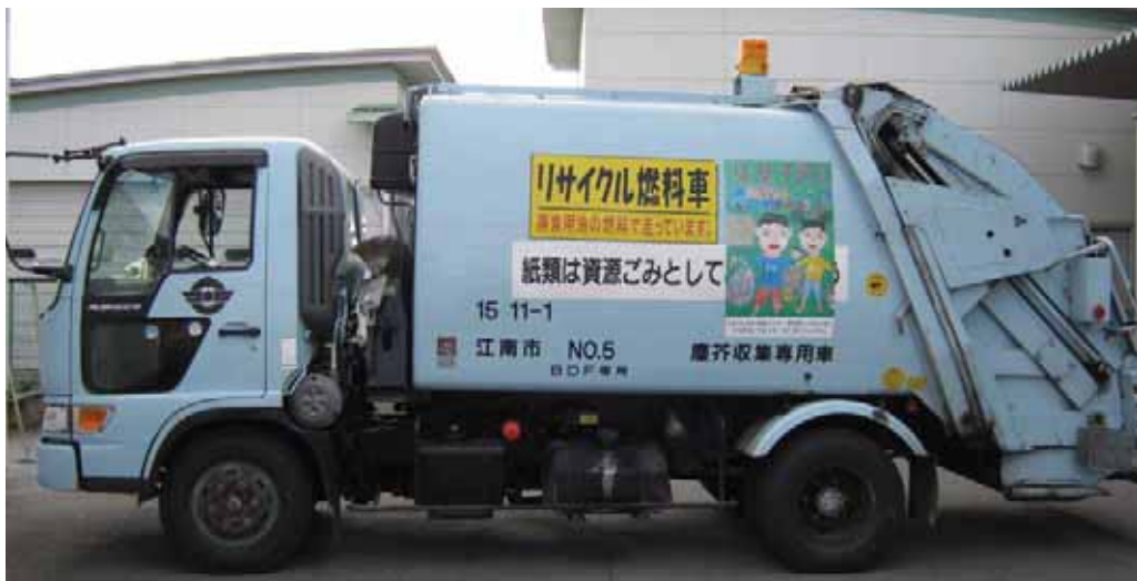
△市の塵芥収集車は、廃食用油をリサイクルしてつくられるBDF(バイオ・ディーゼル・フューエル)を燃料として使用しています。
